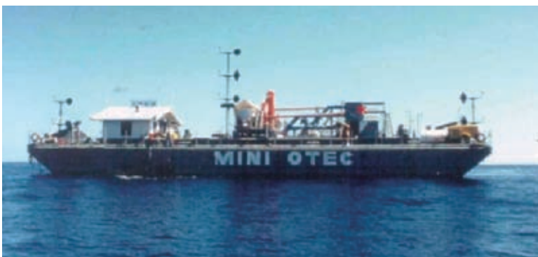
1979年在夏威夷試驗成功的第1座海洋溫差發電廠
